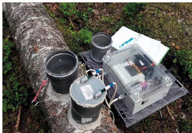
Камеры и портативный газоанализатор для измерения дыхания валежа в целом, а также коры и древесины в отдельности. Фото: пресс-служба заповедника «Кивач»
